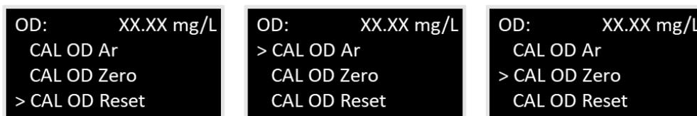
Figura 12 - Sequência de calibração do sensor de Oxigênio Dissolvido.
