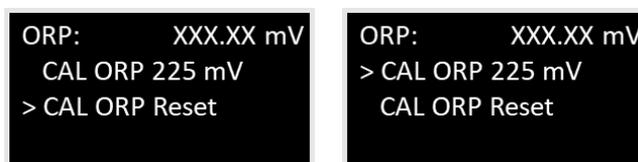
Figura 16 - Sequência de calibração do Sensor de ORP.
